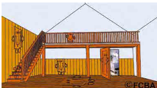
Classe d'emploi 1 Intérieur, sec, volume chauffé
